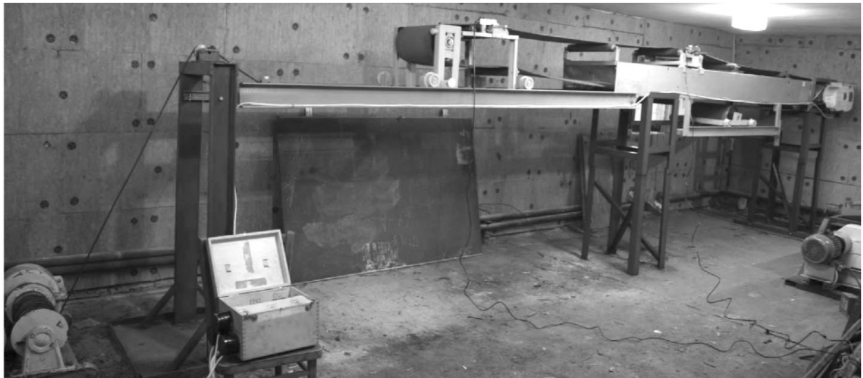
Рис. 3. Общий вид экспериментального конвейера для исследования нагрузки ленты возникающей во время изменения длины транспортирования
